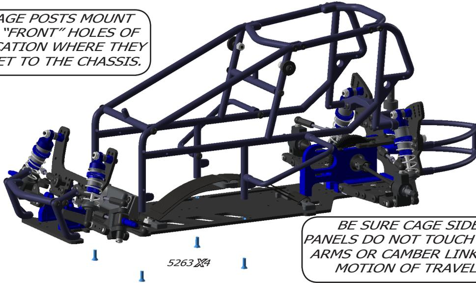
BE SURE CAGE SIDE PANELS DO NOT TOUCH SUSP ARMS OR CAMBER LINKS IN MOTION OF TRAVEL!
